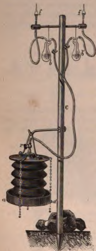
Fig. 100. — Appareil de l'auteur pour recueillir les germes atmosphériques. — ff , tubes-filtres à sulfate de soude. — aa' , aspirateur aux trois quarts détendu. — bb' , barboteurs pour régler le courant d'air. — C , bâton de montagne planté dans le sol.
